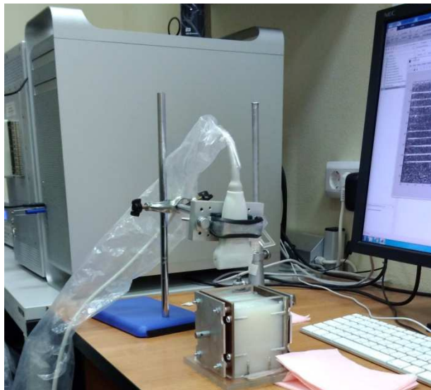
Рис. 2. Акустическая система Verasonics и фантом скелетной мышцы
